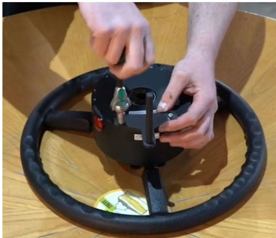
Abbildung 6: Befestigung des Befestigungswinkels
