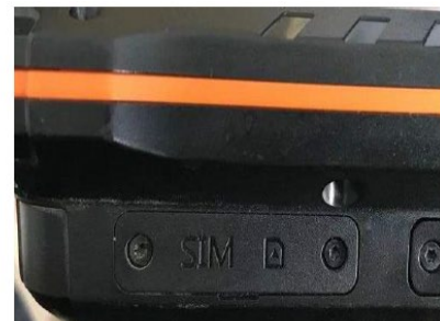
Abbildung 22: Steckplatz der Mobilfunkkarte im Bedien-Tablet
