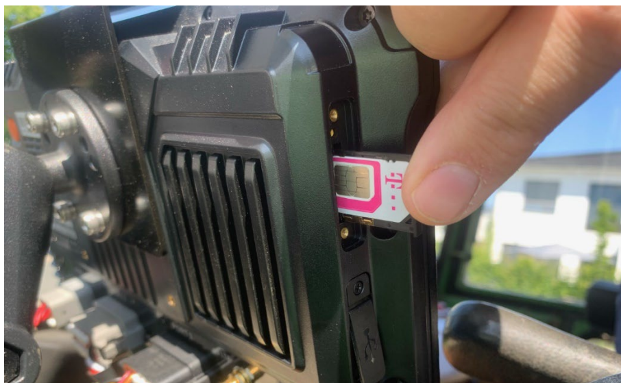
Abbildung 23: Einstecken der Mobilfunkkarte in das Bedien-Tablet
