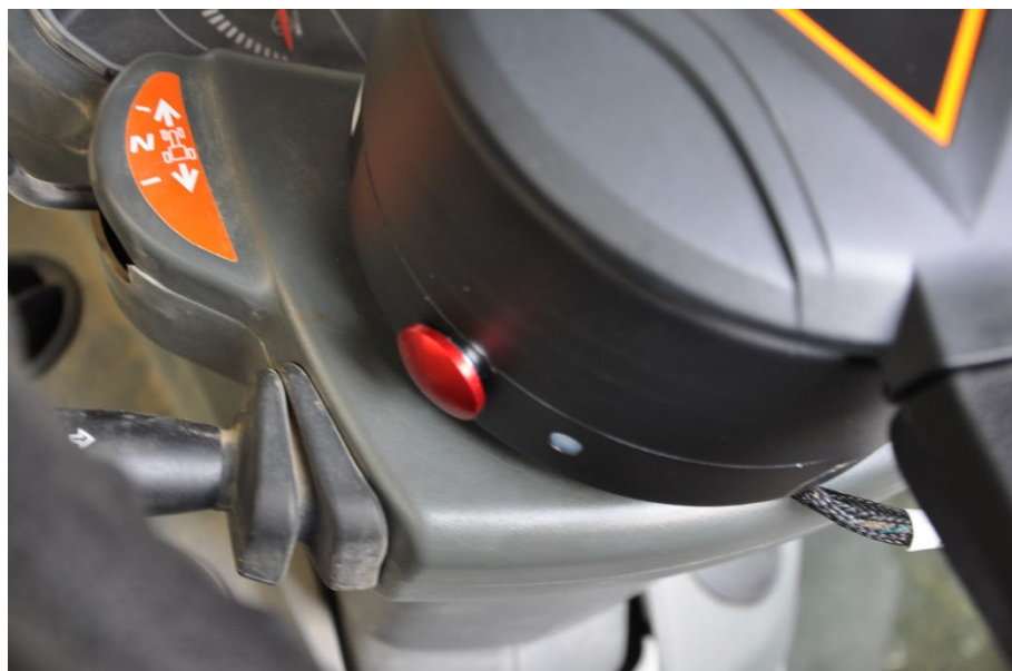
Abbildung 25: Taster zum Wechsel zwischen Manuell- und Automatikmodus
