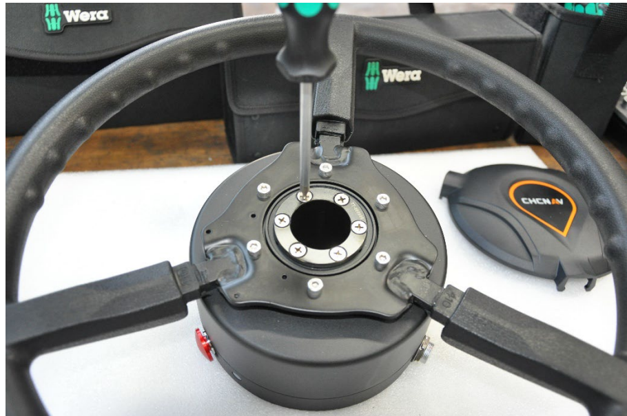
Abbildung 5: Befestigung der Keilwellen-Hülse
