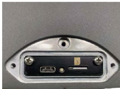
Abbildung 22: Steckplatz der Mobilfunkkarte im Bedien-Tablet
