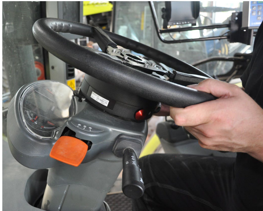
Abbildung 7: Aufsetzen auf Keilwelle
